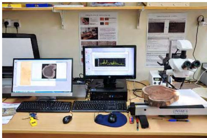
Fig. 18 : Table de lecture Lintab permettant l'observation des échantillons ainsi que la mesure de la largeur des cernes de croissance
